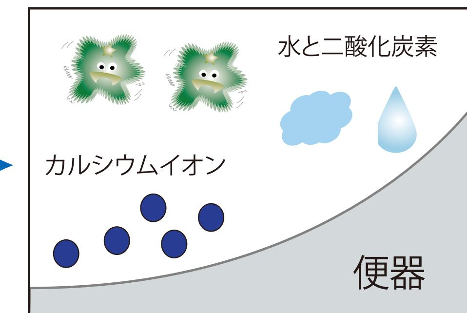
バクテリアは細胞分裂を繰り返しながら尿素を水と二酸化炭素に変えていくため、pHはアルカリ性に傾くことなく、難溶解性物質を形成しない。
