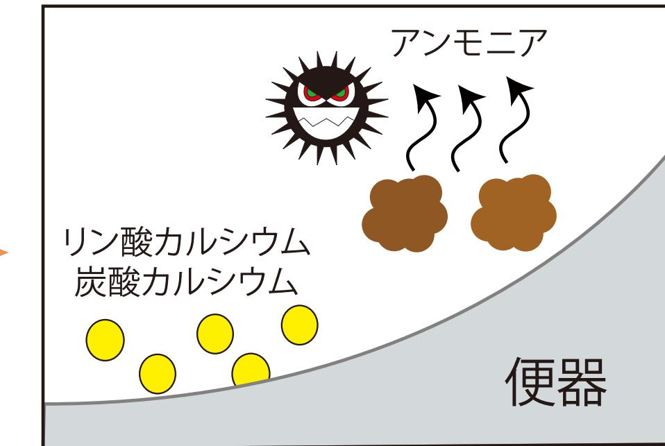
雑菌の酵素により尿素がアンモニアに変化し、pHがアルカリ性になる。それにより尿や水に含まれるカルシウムイオンがリン酸カルシウムなどの難溶解性化合物に変化していく。
