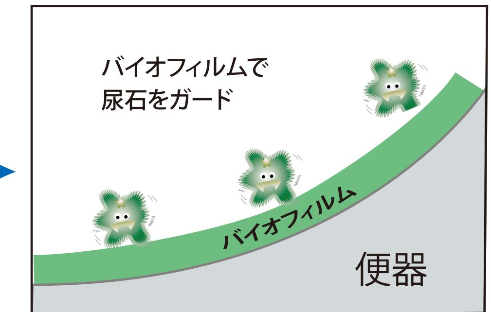
バクテリアは便器面や排水管内にバイオフィルムを形成し、持続的に雑菌を抑制し、尿石の形成を防止する。
